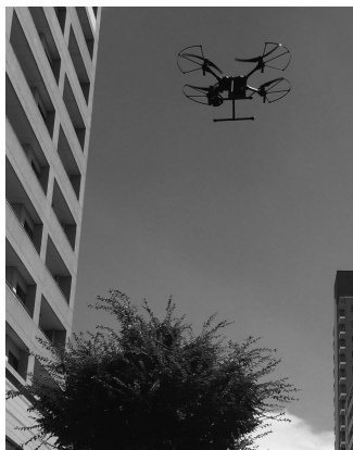
ドローンによる赤外線調査 (一社) 日本赤外線劣化診断技術普及協会 提供
